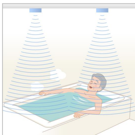
<超音波センサーにより入浴者の頭部位置を測定>
