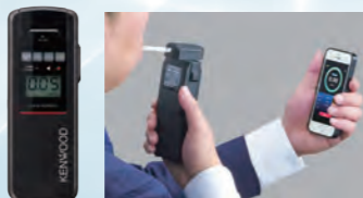
アルコール検知器 [CAX-AD100] 画像はスマートフォンと連携して 測定結果を管理者のPCにメールで送信する 通信型アルコール検知器製品イメージ
