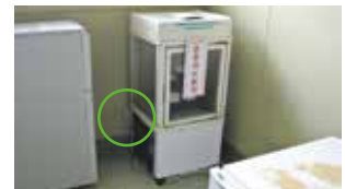
発煙硝酸保管冷蔵庫の固定
