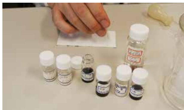
液体クロマトグラフィー法によるフタル酸エステル類のスクリーニング試験
