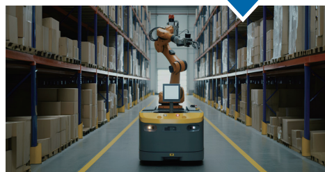
ロボットアーム搭載 AMR にセンサーフュージョンカメラの設置し、周辺環境情報やピッキング対象を取得。自律運転最適ルートを走行しながらアームを制御しピッキングを行う。
