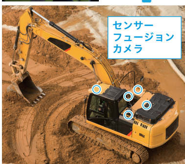
建機に搭載したセンサーフュージョンカメラの情報をもとに作業現場のデジタルツインを作成し建機の遠隔操作へ活用
