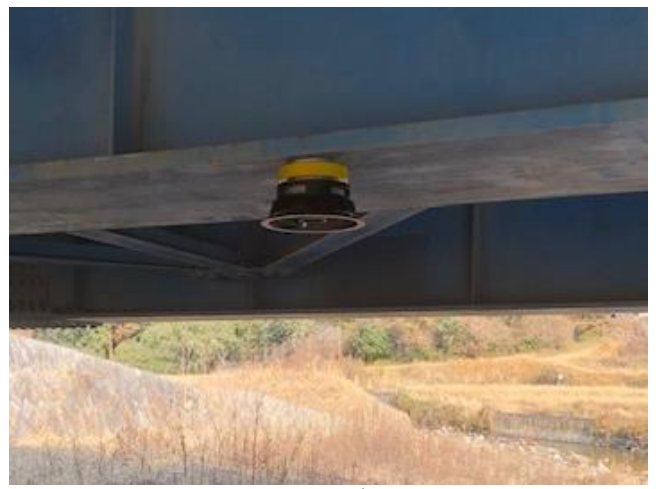
＜橋梁下部に設置したエネルギーハーベスター試作機＞
