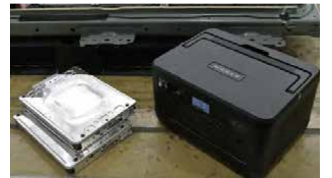
製品に使用されるリーフの再生バッテリーセル(左)と開発中の製品イメージ(右)
