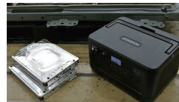
製品に使用されるリーフの再生バッテリーセル(左)と開発中の製品イメージ(右)
