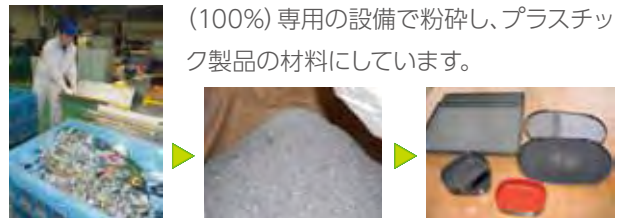
粉碎後、外部業者へ引き渡し、塗装り容器の素材などに再生されます
