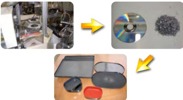
品質検査で不合格となったディスクは、粉碎後、外部業者へ引き渡し、漆塗り容器の素材などに再生されます
