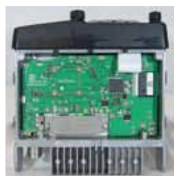
シールド性を持たせたプリント基板
