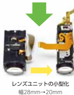
強度解析で耐久性を損なわずにレンズユニットを小型化
