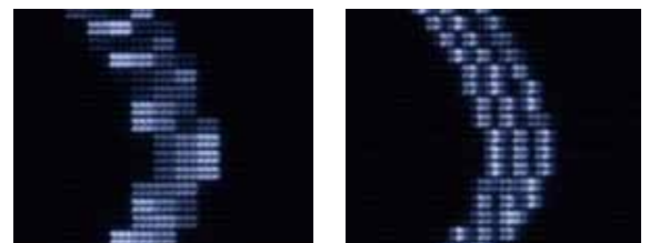
図2 サブピクセル独立ドライブの概念図と3本の微細なラインの表示による画質の比較
